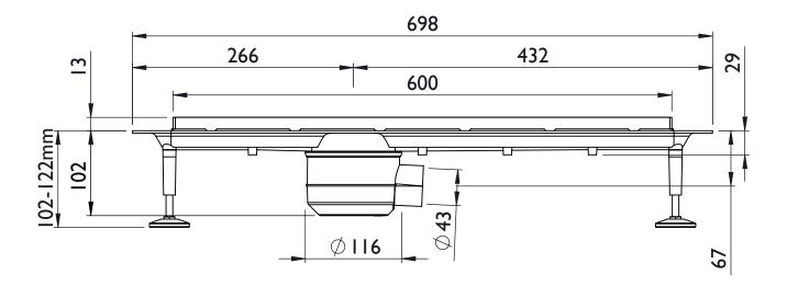
TILED LINEAR 600 - VERTICAL OUTLET - SCREEDED
