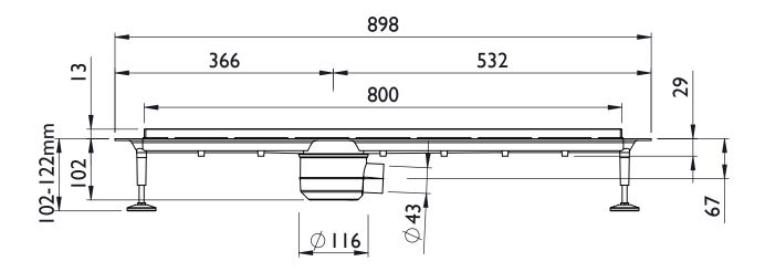
TILED LINEAR 800 - VERTICAL OUTLET - SCREEDED
