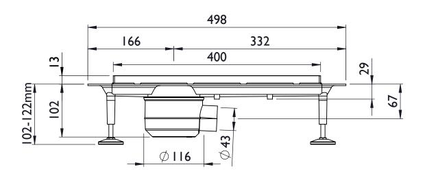
TILED LINEAR 400 - VERTICAL OUTLET - SCREEDED
